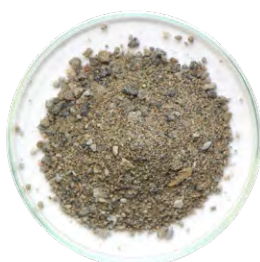
Béton broyé et lavé
